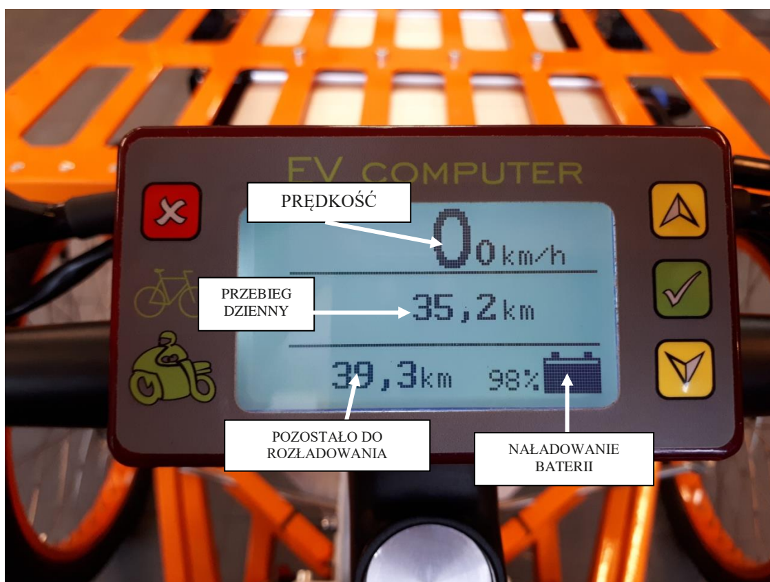
Rys. 8 Przyciski do sterowania ekranem
